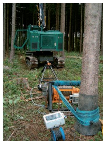
Feldversuch zur Ermittlung der Traktion und deren Auswirkung auf den Waldboden beim Einsatz von Raupenfahrzeugen bei der Holzernte in Zusammenarbeit mit dem KWF
